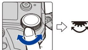
Permite configurar los valores de apertura, la velocidad del obturador y realizar otros ajustes en modos **P / A / S / M**.
