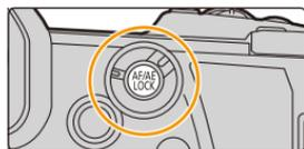
**3** Mientras presiona [AF/AE LOCK], mueva la cámara para componer la imagen y luego presione completamente el botón del obturador.
