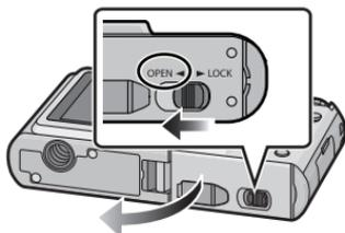
**2** Batterie: Introduisez complètement la batterie jusqu'à ce qu'elle soit verrouillée au moyen du levier de dégagement (A) en faisant attention au sens lors de l'insertion. Tirez sur levier de dégagement (A) dans le sens de la flèche pour retirer la batterie.
