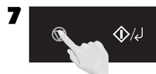
Après le paramétrage, l'écran revient au réglage du choix des unités de poids/température en appuyant sur **Marche/Réglage** à nouveau; appuyer sur **Arrêt/Réenclenchement** pour quitter.
