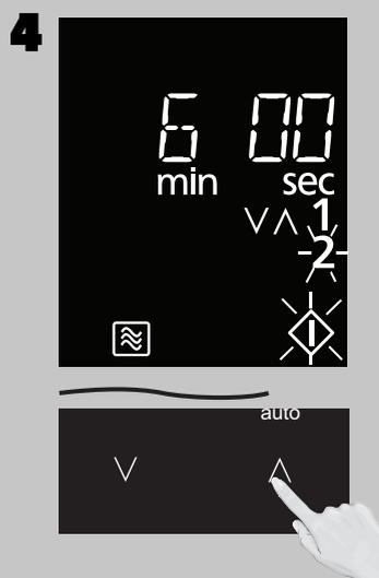
Régler la durée de cuisson en appuyant sur «\»/«^», (voir page 25 pour les durées maximales).
