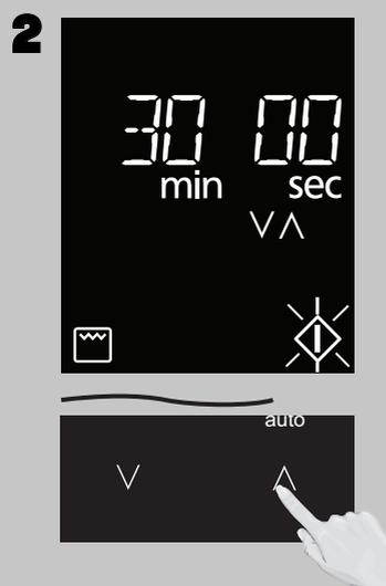
Régler la durée de cuisson souhaitée en appuyant sur « V » / « ^ ».
