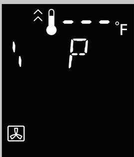
Appuyer sur **Marche/Réglage** pour préchauffer. L'indication « PRÉCHAUFFAGE » défile une fois à l'écran, un « P » s'affiche ensuite. Quand le préchauffage est terminé, le four émet un bip et l'indication « P FIN » s'affiche à l'écran. Ouvrir ensuite la porte et placer les aliments à l'intérieur.
