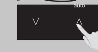
Régler la durée de cuisson souhaitée en appuyant sur « V » / « A » (jusqu'à 9 heures).
