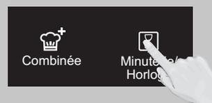
Lorsqu'il n'y a PAS de cuisson en cours dans le four, appuyer deux fois sur **Minuterie/Horloge**; le deux-points clignote.
