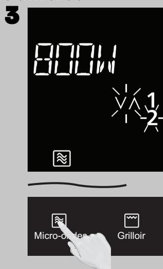
Appuyer sur **Micro-ondes** jusqu'à ce que le niveau désiré de puissance s'affiche à l'écran. 1 000 W est le niveau le plus élevé et 100 W, le plus faible.
