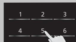
Régler la durée de cuisson désirée avec les touches **numériques** (jusqu'à 99 minutes, 99 secondes).
