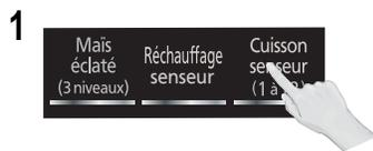
Appuyez sur **Cuisson senseur** jusqu'à ce que le numéro correspondant à l'aliment désiré apparaisse à l'écran (**voir le tableau à la page suivante**).
