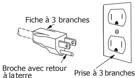
La fiche doit être branchée dans une prise correctement installée et reliée à la terre.
