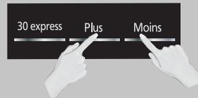
Au besoin, appuyer une fois sur **Plus** pour ajouter 10 secondes ou deux fois pour ajouter 20 secondes. Appuyer une fois sur **Moins** pour soustraire 10 secondes ou deux fois pour soustraire 20 secondes.
