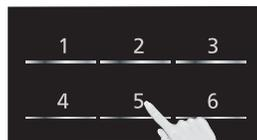
Régler la durée d'attente à l'aide des touches **numériques** (jusqu'à 99 minutes, 99 secondes).
