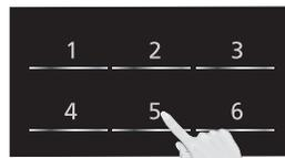
Régler la durée de maintien au chaud avec les touches **numériques**, jusqu'à 30 minutes. Cet exemple indique deux minutes. À la fin du maintien au chaud, 5 bips se font entendre.
