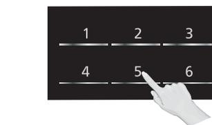
Régler la durée de cuisson avec les touches **numériques**. Pour les autres niveaux de puissance, la durée maximale programmable est de 99 minutes, 99 secondes.
