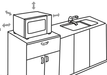
(a) **NE PAS** obstruer les événements d'aération. Si ceux-ci devaient être obstrués pendant le fonctionnement de l'appareil, le four risque de surchauffer et d'être endommagé.
