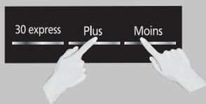
Au besoin, appuyer sur **Plus** pour augmenter la durée de cuisson de 20 %. Appuyer sur **Moins** pour diminuer la durée de cuisson de 20 %.
