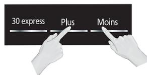
Au besoin, appuyer sur **Plus** pour augmenter la durée de cuisson de 20 %. Appuyer sur **Moins** pour diminuer la durée de cuisson de 20 %.
