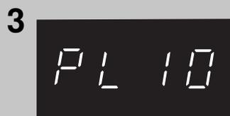
Appuyer sur **Puissance micro-ondes** jusqu'à ce que le niveau de puissance désiré s'affiche dans la fenêtre d'affichage. PL10 est le plus élevé et PL1 est le plus faible.
