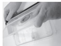
Ouvrir le capuchon d'arrivée d'eau, enlever le couvercle et l'embout du tuyau et procéder au nettoyage.
