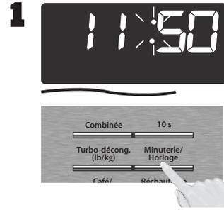
Lorsqu'il n'y a pas de cuisson en cours dans le four, appuyer deux fois sur **Minuterie/Horloge**; le deux-points (:) clignote. Entrer l'heure du jour à l'aide des touches de **durée**.
