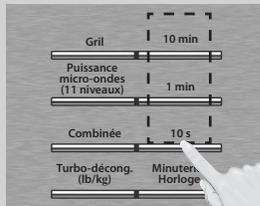
Régler la durée de cuisson désirée à l'aide des touches de **durée** (jusqu'à 99 minutes, 50 secondes).
