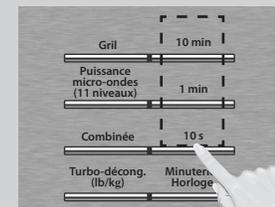
Régler la durée désirée à l'aide des touches de **durée** (jusqu'à 99 minutes, 50 secondes).
