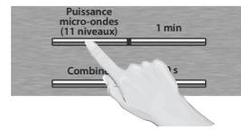
Appuyer sur **Puissance micro-ondes** jusqu'à ce que le niveau désiré apparaisse à l'écran. P10 est le niveau le plus élevé et P1 est le plus faible.
