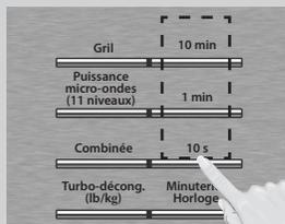
Régler la durée de cuisson à l'aide des touches de **durée** (voir à la page précédente pour les durées maximales).
