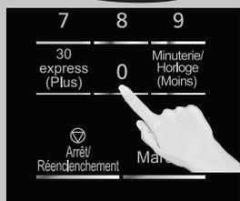
Régler la durée de cuisson avec les touches **numériques**. P10 (ÉLEVÉE) et P0 (MAINTIEN AU CHAUD) offrent une durée maximale de cuisson de 30 minutes. Pour les autres niveaux de puissance, la durée maximale programmable est de 99 minutes, 99 secondes.
