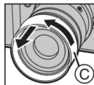
**2 Alinee la marca (B) ( ) en la visera de la lente con la marca en el extremo de la lente.**
