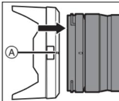
**2 Drehen Sie die Gegenlichtblende in Pfeilrichtung, bis die Markierung B (○) an der Gegenlichtblende an der Markierung am Objektivrand ausgerichtet ist.**
