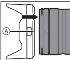
**2 Faites tourner le parasoleil dans le sens de la flèche pour aligner le repère B (○) présent sur le parasoleil sur le repère situé à l'extrémité de l'objectif.**
