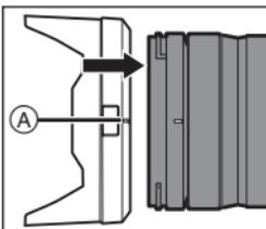
**2 朝箭頭指示的方向轉動鏡頭遮光罩,將鏡頭遮光罩上的標記Ⓑ(○)對準鏡頭頂端的標記。**
