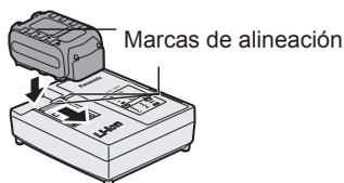
3. La luz indicadora de carga permanecerá encendida durante la carga. Cuando haya terminado la carga, se accionará automáticamente un conmutador electrónico interno para impedir cualquier sobrecarga.
