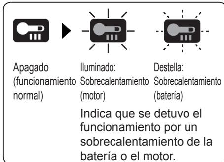
Para proteger el motor o la batería, asegúrese de observar lo siguiente cuando efectúe esta operación.
