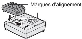
3. Pendant la charge, le témoin s'allume. Lorsque la charge est terminée, un interrupteur électronique s'actionne pour protéger la batterie.
