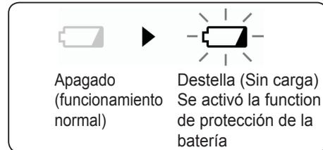
Una descarga excesiva (completa) de las baterías de Li-ión acorta dramáticamente su vida de servicio. El destornillador contiene una función de protección de batería diseñada para evitar una descarga excesiva de la batería.
