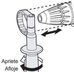
Utilice siempre la empuñadora de apoyo para asegurarse de que opera la herramienta en forma segura.
