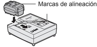
3. **La luz indicadora de carga permanecerá encendida durante la carga. Cuando haya terminado la carga, se accionará automáticamente un conmutador electrónico interno para impedir cualquier sobrecarga.**
