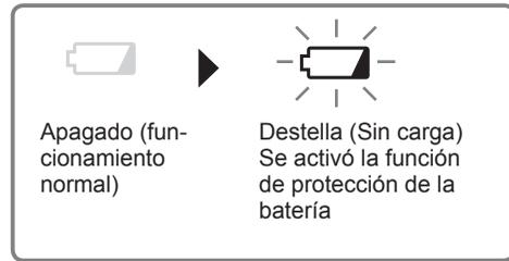
Una descarga excesiva (completa) de las baterías de Li-ión acorta dramáticamente su vida de servicio. El destornillador contiene una función de protección de batería diseñada para evitar una descarga excesiva de la batería.
