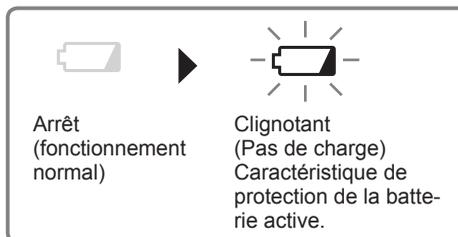
Une décharge excessive (totale) des batteries aux ions de lithium réduit leur durée de vie de façon notable. L'outil comprend une caractéristique de protection de la batterie conçue pour empêcher une décharge excessive de la batterie autonome.
