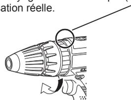
Si la poignée d'embrayage ne peut pas être réglée sur le mode de perçage ou de percussion après le perçage avec la fonction embrayée, placez la poignée d'embrayage en position 1 et utilisez l'embrayage pendant une seconde.
